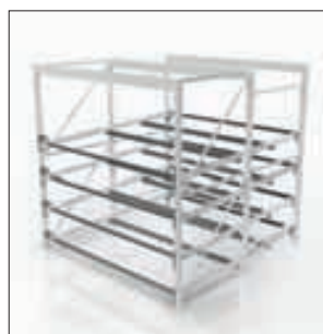
3. Montage des lisses
