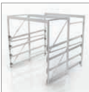
1. Montage des longerons
