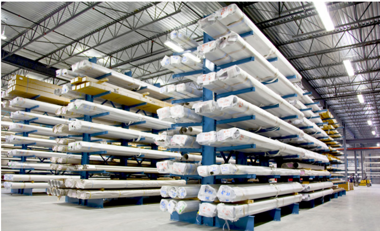
Photo : Rayonnage en porte-à-faux pour l'entreposage de tuyauterie et de tubes métalliques
