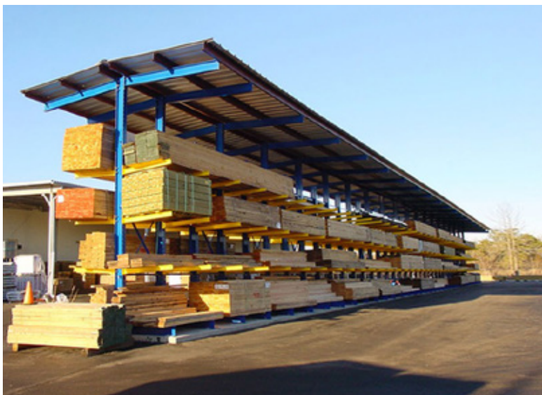
Photo : Rayonnage en porte-à-faux pour parc à bois débités
