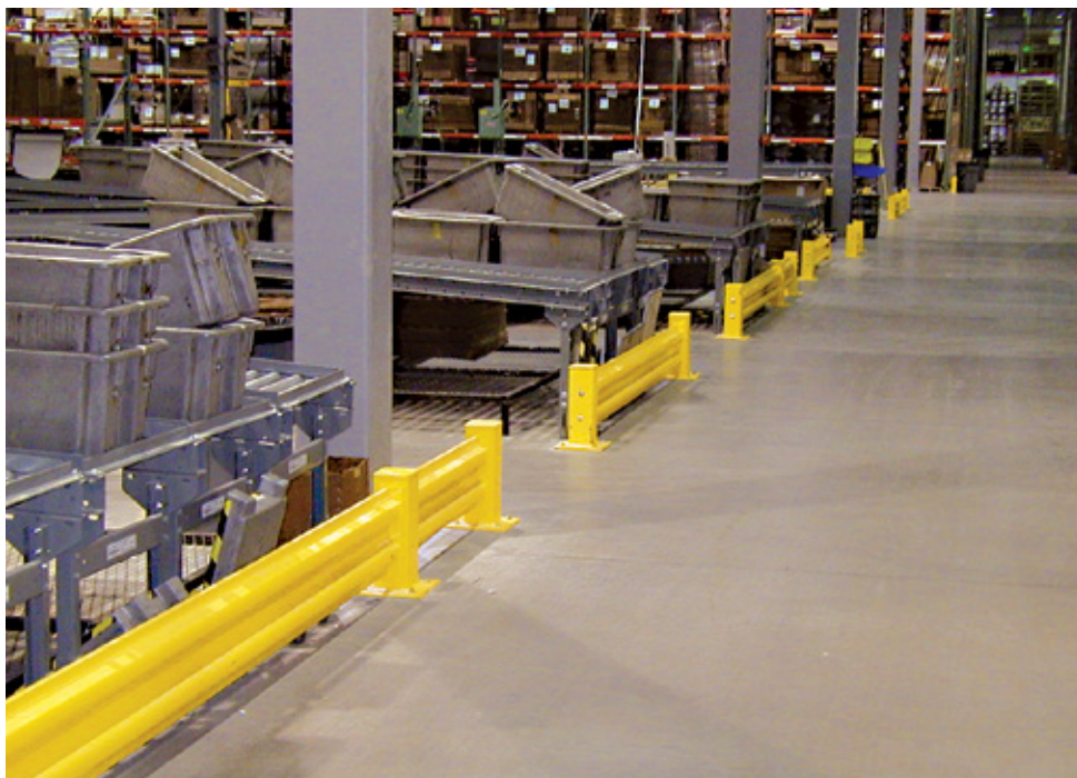
Photo : Parapet de protection d'équipement à rail simple
